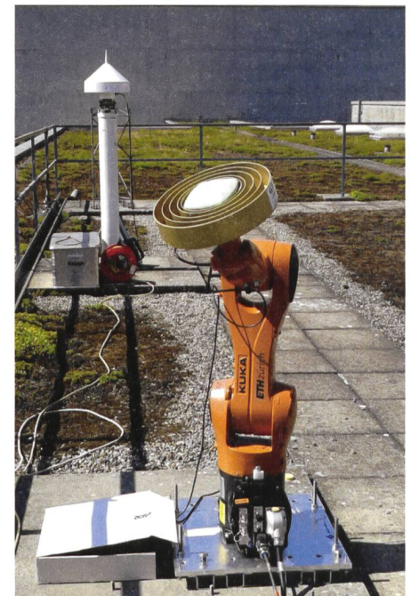
Abb. 3: KUKA 6-Achsen Industrieroboter auf dem Dach des Instituts für Geodäsie und Photogrammetrie der ETH Zürich auf dem Hönggerberg. Im Hintergrund ist die Referenzantenne zu sehen.
