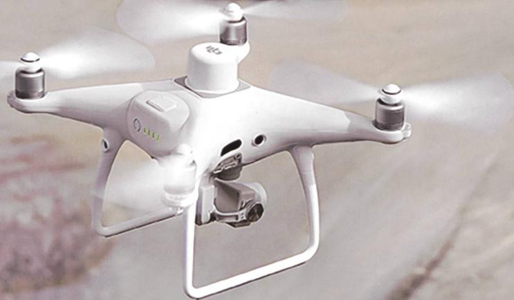
Die Mapping-Drohne DJI Phantom 4 RTK ist speziell für 3D-Mapping ausgelegt und liefert zentimetergenaue Positionsdaten bei deutlich weniger benötigten Kontrollpunkten am Boden.
