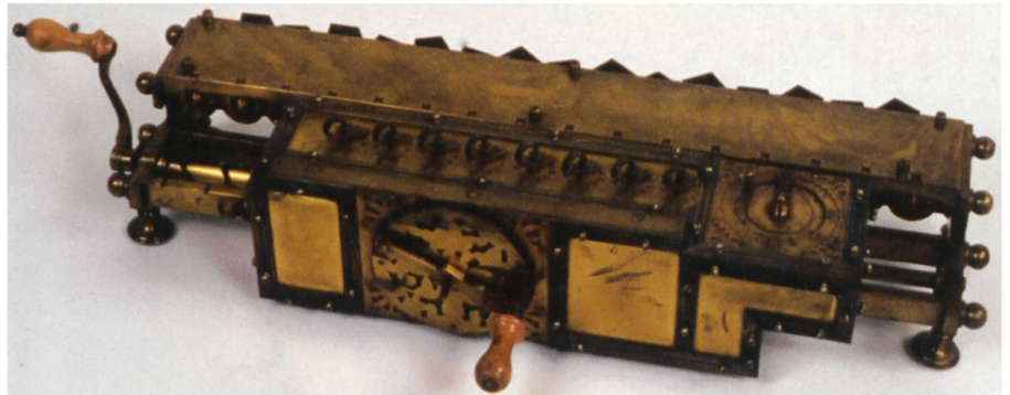
Abb. 3: Nachbau der Leibniz-Rechenmaschine von Roberto Guatelli. Gottfried Wilhelm Leibniz (1646–1716) baute seine erste Rechenmaschine 1673. Das einzige erhaltene Exemplar stammt aus den 1690er-Jahren und wird in Hannover verwahrt. Es ist die weltweit erste mechanische Rechenmaschine, die alle vier Grundrechenarten beherrscht (© Museo nazionale della scienza e della tecnologia «Leonardo da Vinci», Mailand).
