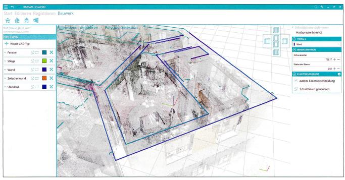
Abb. 1: Workflow horizontaler Schnitt durch ein Gebäude.
