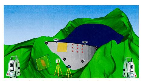
Fig. 7: Illustration schématique de la combinaison de quelques techniques géodésiques.
