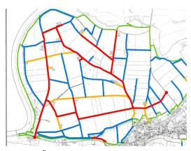
Abb. 2: Übersicht Wegnetz: rot = neue 40 t Haupterschliessung; orange = übrige Belagsstrassen bzw. Hofzufahrten; blau = Kieswege.
