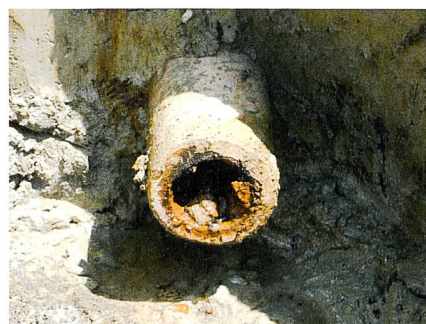
Abb. 12: Alte Saugleitung (Ton), teilweise verstopft.
