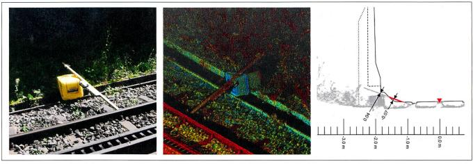
Fig. 3: Atteinte artificielle provoquée sur le gabarit d'implantation des obstacles, vue sur place, dans le nuage de points et dans le profil transversal.
