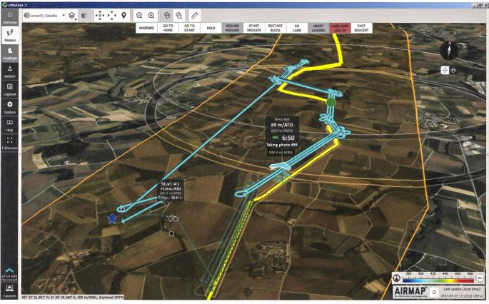
Fig. 3: Une partie de l'interface du PIC, avec le tracé du gazoduc en jaune, le corridor réservé pour le BVLOS en orange, la trajectoire du drone en cyan, la position du PIC en bleu et celle de l'observateur en vert et son espace d'observation (rayon = 2 km) en grisé.
