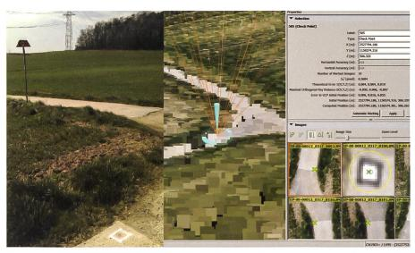
Fig. 2: La mesure d'un PFP3 3D disponible sur le tracé, à titre de contrôle uniquement, la géolocalisation se faisant sur la base du GNSS précis en mode RTK et PPK. A gauche, le point avant signalisation; à gauche, la vue 3D du faisceau de rayons; à droite, les multiples mesures monoscopiques et les écarts résultants.
