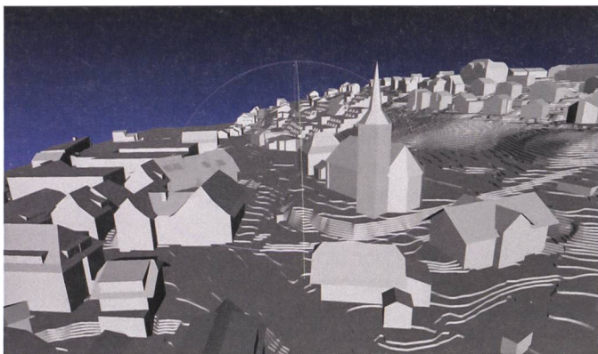
Abb. 2: Ausschnitt aus dem Stadtmodell Steffisburg, vorwiegend mit Laserscanning hergestellt.
