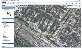
Darstellung der Gleisinfrastruktur in GeoTrAMS.
