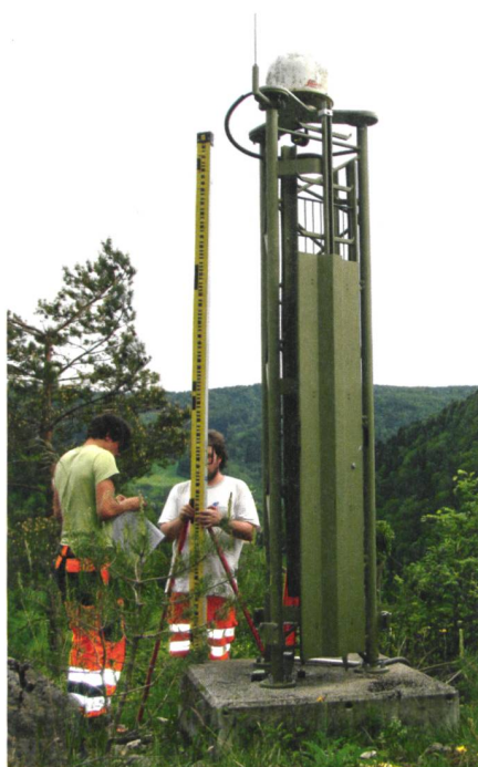
Abb. 5: GNSS-Referenzstation MTTI – eingebunden ins AGNES-Netz CH.
