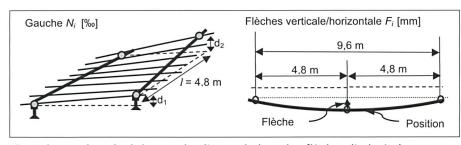
Fig. 2: bases du calcul du gauche (à gauche) et des flèches (à droite).
