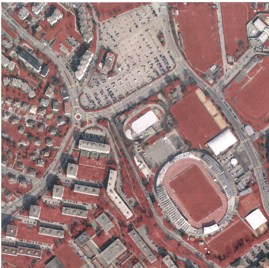
Fig. 4: Carte NDVI d'un quartier de la ville de Lausanne drapée sur un extrait de SWISSIMAGE RGB. Les pixels rouges ont une valeur supérieure à 0.1 et indiquent la présence de végétation.
