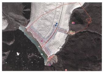
Abb. 3: Flugplan (rote Linie) der Flüge über die Kalbungsfront und die DGPS-Kontrollpunkte (rote Dreiecke). Zusätzlich die Lokalitäten der Seismik- und Infrasound-Arrays (violette Punkte), der Timelaps-Kameras (rote Vierecke) und das Camp der Expedition 2015 (grünes Dreieck).
