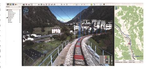
Abb. 1: Ein Ausschnitt aus dem Infra3D Web-Service mit dargestellten Fahrdrahtmessungen.
