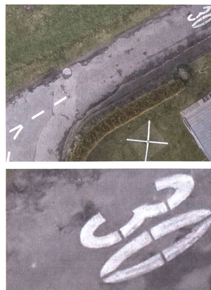
Abb. 4: Ausschnitt aus einer Befliegung mit dem UX5 HP: Bodenauflösung 1.3 cm.
