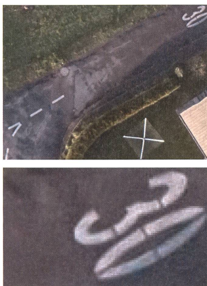
Abb. 3: Ausschnitt aus einer Befliegung mit dem UX: Bodenauflösung 2.6 cm.
