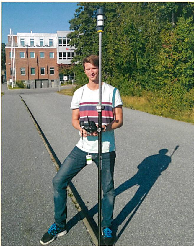
Das neue und leichte Trimble Aktivprisma AT360 ist das ideale Werkzeug für Robotic-Vermessungen und ist mit allen Trimble Totalstationen der S-Serie kompatibel.
