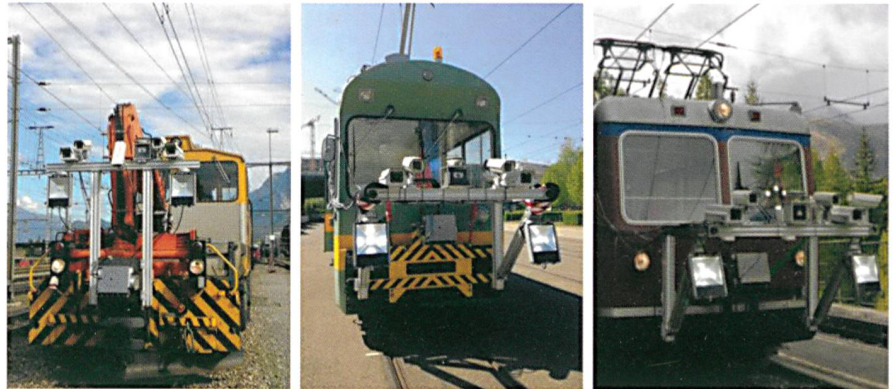
Abb. 3: Der Rail Track Scanner aus dem TQual-Projekt im Einsatz bei der Rhätischen Bahn, den Verkehrsbetrieben Zürich und der Gornergratbahn.
