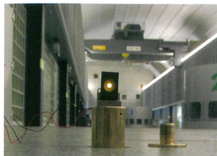
Fig. 1: Le système Daedalus mis en place pour la détection de mouvements extrêmement petits dans une usine électrique.
