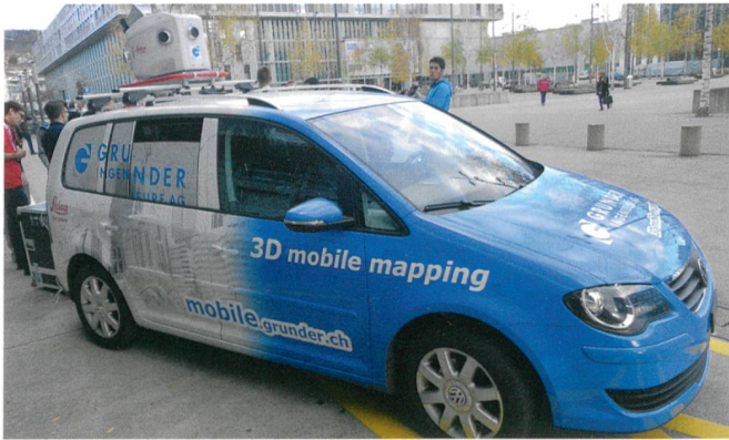
Das Mobile-Mapping Fahrzeug der Grunder Ing. AG mit dem Pegasus Two System.
