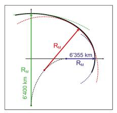
Abb. 4: Meridian-Krümmungsradien des Erdellipsoides sind Breiten abhängig.
