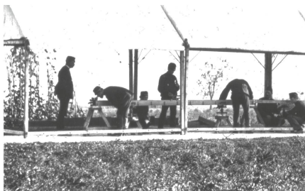
Abb. 2: Messung mit dem spanischen Basis-Messapparat, Aarberg, 1880 (Foto: swisstopo).
