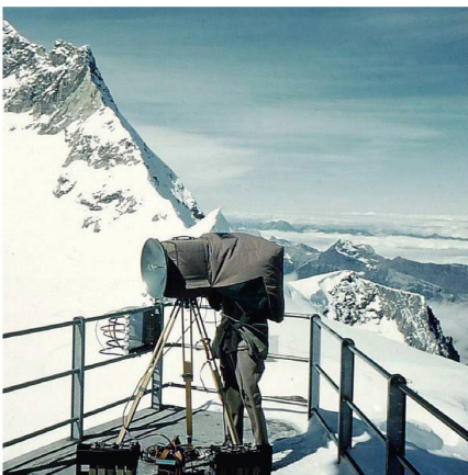
Abb. 5: Erste EDM in der Schweiz mit Tellurometer M/RA1 auf Jungfraujoch, 1958 (Foto: Tellurometer Ltd., UK).
