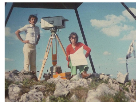
Abb. 9: EDM der L+T auf TP 1. Ord. Suchet VD mit Geodimeter 8, 1976; Operateur: A. Carosio (Foto: A. Carosio).
