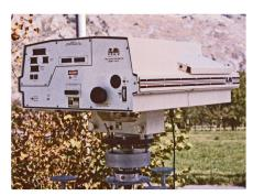
Abb. 12: Zweifarben EDM, Terrameter LDM2 im Testnetz Turtmann 1986 (Foto: swisstopo).
