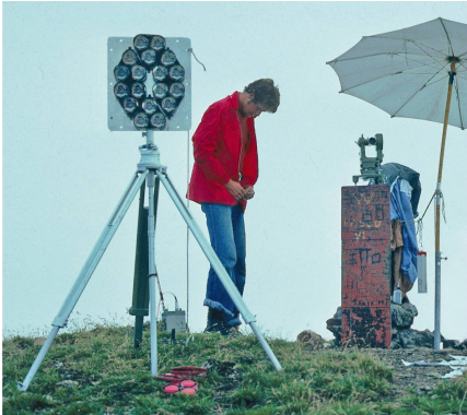
Abb. 8: Reflektorstation mit Prismenarray (Foto: S. Heggli).
