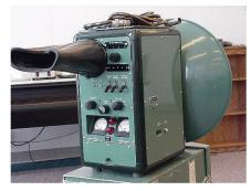
Abb. 4: Tellurometer M/RA1 (Foto: NOAA).
