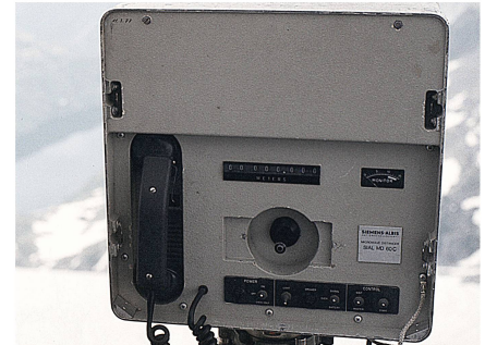
Abb. 11: EDM mit SIAL MD60, Alpen-traverse Gotthard (Foto: D. Steudler).
