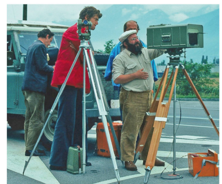
Abb. 7: EDM mit AGA Geodimeter 8 des IGP 1975 mit W. Schneibel (Operateur) und W. Fischer, Projektleiter (l.) (Foto: S. Heggli).
