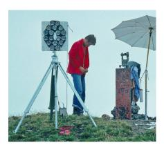
Abb. 8: Reflektorstation mit Prismenarray (Foto: S. Heggli).
