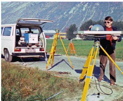
Abb. 15: Erster geodätischer GPS-Empfänger Macrometer V-1000 im Testnetz TURTMANN (Foto: swisstopo).
