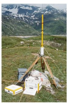
Abb. 14: TRANSIT-Dopplerempfänger Magnavox MX-1502 (Foto: GGL/ETHZ).
