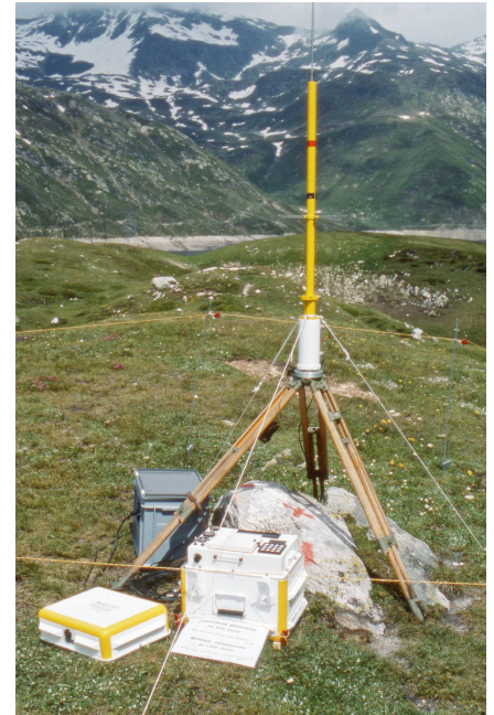
Abb. 14: TRANSIT-Dopplerempfänger Magnavox MX-1502 (Foto: GGL/ETHZ).
