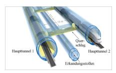
Abb. 8: Die beiden Hauptröhren und der Erkundungsstollen beim Brenner Basistunnel (Quelle BBT SE © 2011, Beschr. geändert).
