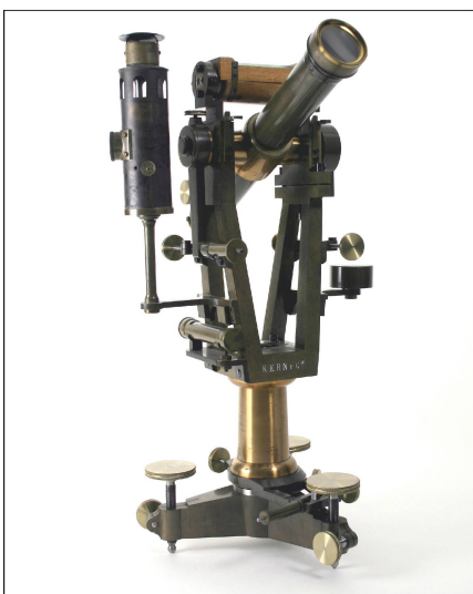
Abb. 2: Grosser Absteckungs-Theodolit für Simplontunnel, um 1898.
