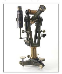
Abb. 2: Grosser Absteckungs-Theodolit für Simplontunnel, um 1898.
