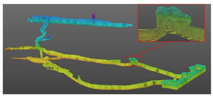
Abb. 4: Höhenschnitte durch den gesamten Stollen, eingefärbt nach Höheninformation.
