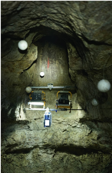
Abb. 2: Hängende Stationierung des Scanners mit Beleuchtung und Verknüpfungspunkten (Foto: Yvo Weidmann, Geoldee).
