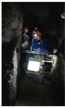
Abb. 3: Spannstativ mit aufgesetztem Scanner und Akkuscheinwerfer sowie mit Styroporkugeln signalisierte Verknüpfungspunkte. (Foto: Yvo Weidmann, Geoldee).
