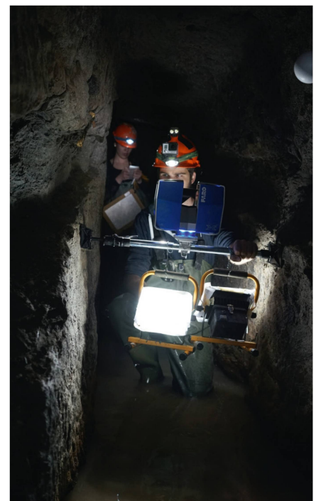
Abb. 3: Spannstativ mit aufgesetztem Scanner und Akkuscheinwerfer sowie mit Styroporkugeln signalisierte Verknüpfungspunkte. (Foto: Yvo Weidmann, Geoldee).
