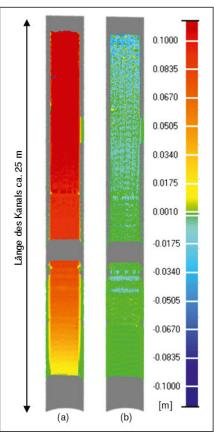
Fig. 5: Deviazioni verticali della nuvola di punti misurati attraverso l'acqua rispetto al modello di riferimento (altezza dell'acqua di 150 mm ca.), senza correzione (a) e con correzione (b). Abb. 5: Vertikale Abweichungen der Punktwolke vom Referenzmodell bei Scan durchs Wasser (MS50; ca. 150 mm Wasserhöhe), ohne Korrektur (a)
