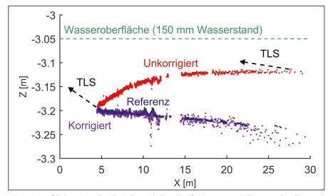
Fig. 6: Profili longitudinali del modello di riferimento, della nuvola di punti corretta e della nuvola di punti non corretta. Altezza dell'acqua: 150 mm (scala verticale della rappresentazione esagerata).
