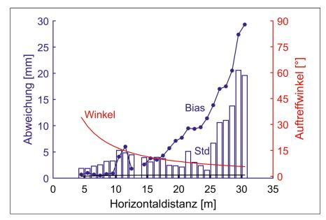
Fig. 7: Deviazione standard campionaria (std) e valor medio degli scarti verticali fra la nuvola di punti corretta e la referenza (bias) al variare della distanza orizzontale dallo scanner e dell'angolo di incidenza del fascio laser sulla superficie dell'acqua (profondità 150 mm).
