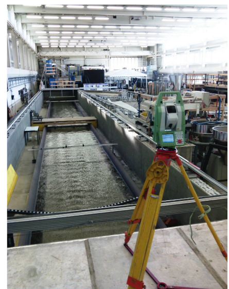
Abb. 4: Hydrologisches Modell eines Kanals im Labor der VAW.
