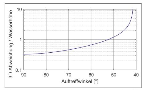
Abb. 3: 3D-Abweichung zwischen scheinbarem und wahrem Punkt auf der Gewässersohle in Abhängigkeit vom Auftreffwinkel bei perfekt horizontaler Wasseroberfläche und Gewässersohle.
