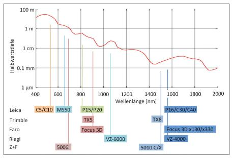
Abb. 1: Dämpfung optischer Strahlung in Wasser in Abhängigkeit von der Wellenlänge (Halbwertsschichtdicke mit Daten aus Hale und Querry [1973] berechnet), ungefähre Trägerwellenlänge ausgewählter terrestrischer Laserscanner. Fig. 1: Assorbimento del raggio in acqua in funzione della lunghezza d'onda (strato emivalente calcolato coi dati di Hale e Querry [1973]); le lunghezze d'onda dei laser scanner scelti sono solo indicative.
