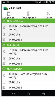
Abb. 4: Pegelstände aus dem System ELWIS.
