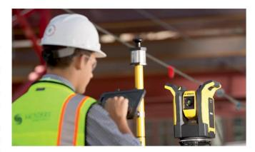
ungehinderter Sicht in der Vertikalen schnell ein Deckenlayout übertragen. Die automatische Einrichtung (Autostationing) der Station ermittelt auf Knopfdruck die Position des Instruments auf der Baustelle. So ist das System schneller einsatzbereit und erfordert weniger Fachkenntnisse als bisher verfügbare Lösungen.
