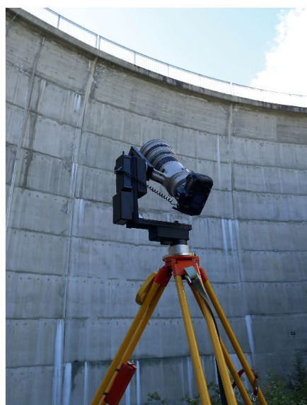
Fig. 2: Appareil photo avec un objectif de 400 mm monté sur la tête panoramique.
