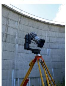
Fig. 2: Appareil photo avec un objectif de 400 mm monté sur la tête panoramique.
