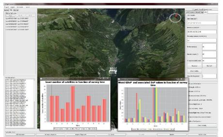
Fig. 4: Prévision de la disponibilité des satellites de la constellation GPS sur les points de passage. Ici, visibilité des satellites dans la vallée très encastrée de Lauterbrunnen pour le 13 Janvier 2015 entre 10:13 et 20:13 à une heure d'intervalle.
