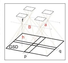
Fig. 2: f correspond à la distance focale, B la base (distance entre deux prises de vue), à la distance entre deux lignes consécutives, GSD est la taille d'échantillonage (taille d'un pixel sur le terrain), p est le recouvrement longitudinal et q le recouvrement latéral.
