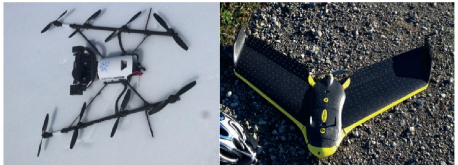
Abb. 1: AscTec Falcon 8 Copter mit einer Sony NEX-7 Kamera (links); Starrflügler eBee mit einer Canon IXUS/ELPH (rechts).
