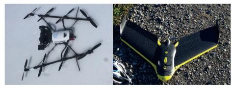
Abb. 1: AscTec Falcon 8 Copter mit einer Sony NEX-7 Kamera (links); Starrflügler eBee mit einer Canon IXUS/ELPH (rechts).
