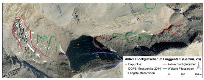
Abb. 2: Permafrost-Testgebiet im Furggentälti nahe des Alten Gemmipass. In rot die Umrandungen verschiedener Blockgletscher, in grüner Farbe markante Solifluktionsloben. Orthophoto und Höhenlinien stammen vom Bildflug im September 2010 (Flotron AG).
