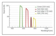
Abb. 3: mulitSPEC 4C mit normalisierter Empfindlichkeit der Kanäle G, R, Red Edge und NIR in [%].
