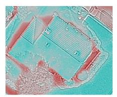
Abb. 10: TIR-Orthophoto pan-sharpened mit GSD von 5 cm.
