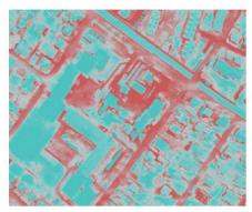
Abb. 9: TIR-Orthophoto mit einer GSD von 15 cm (blau = kalt; rot = 'warm').
