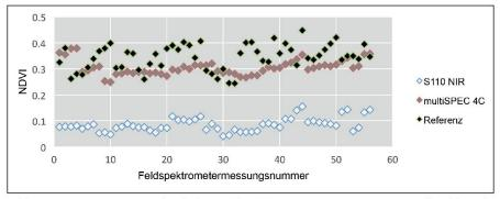
Abb. 6: NDVI-Wertevergleich für multiSPEC 4C, Canon S110 NIR und Feldspektrometer für identische Testplots im Rapsversuch.
