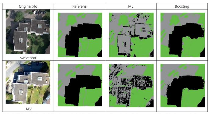
Abb. 2: Bildausschnitte (UAV / swisstopo): Originalbild, manuell ermittelte Referenz, und Klassifikationsergebnisse mit ML und boosting+RQE. Dächer sind schwarz, Strasse/Trottoir sind grau, die Vegetation ist grün.
