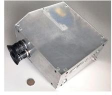
Fig. 1: Système d'acquisition pushbroom utilisant le capteur Headwall.
