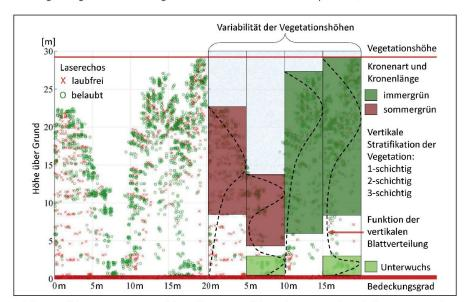
Abb. 2: Ableitung von Waldstrukturvariablen, basierend auf der ALS-Punktwolke.
