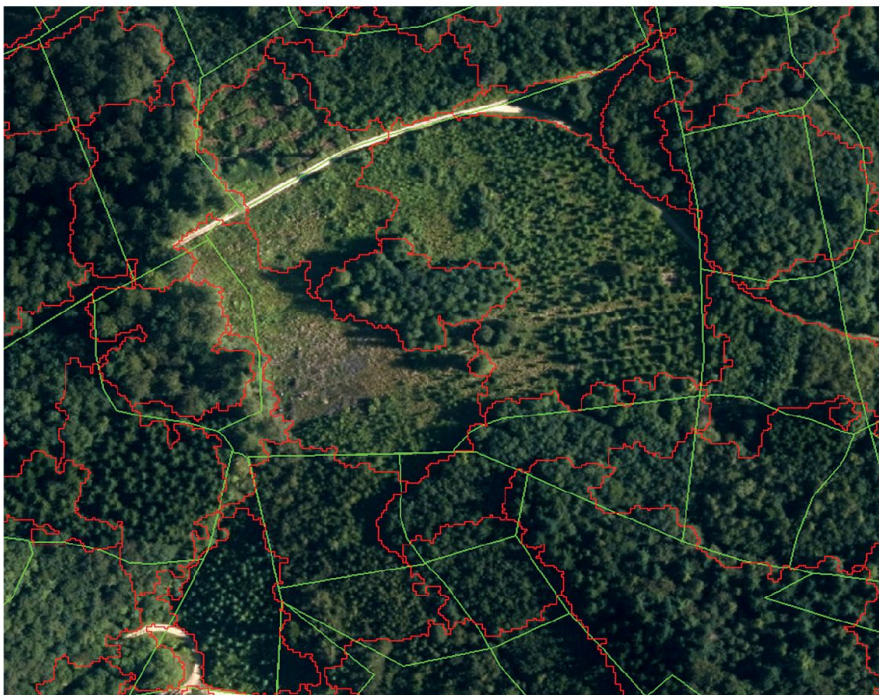
Abb. 4: Automatisierte Ableitung von Polygonen strukturell homogener Waldeinheiten (Rot) in Überlagerung mit den Polygonen der Bestandeskarte des Kantons Aargau (Grün).
