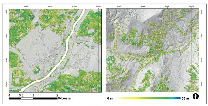
Abb. 3: Beispiele des Vegetationshöhenmodells (VHM), berechnet aus dem digitalen Oberflächenmodell der Stereokorrelation und dem Geländemodell swissALTI3D der swisstopo. Links ein Ausschnitt aus dem Mittelland, rechts ein Ausschnitt an der oberen Waldgrenze.
