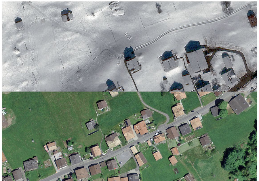
Abb. 1: Bildbeispiel WV03: Orthorektifizierte Winteraufnahme (GSD 30 cm) in der Region Interlaken. Zum Vergleich: SWISSIMAGE (unten). Copyrights: ©2015 DigitalGlobe Inc. / ©swisstopo.
