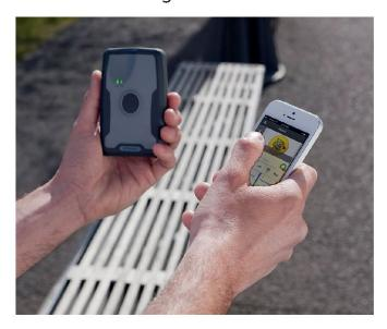
Der neue Trimble R1 GNSS ist ein neuer, robuster und extrem leichter GNSS-Empfänger, welcher die Signale von allen vorhandenen Satellitensystemen (GPS, Glonass, Galileo, QZSS und BeiDou) verarbeitet. Um Submeter-Genauigkeit zu erreichen, kann der Trimble R1 GNSS die Korrekturdatendienste wie swipos-NAV, SBAS oder auch Trimble Viewpoint RTX nutzen. Er kann mittels Bluetooth an Geräte mit iOS, Android und Windows gekoppelt werden und bietet somit höchste Flexibilität im täglichen Einsatz.
