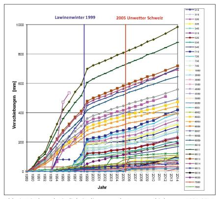
Abb. 6: Kriechgeschwindigkeitsdiagramm der Lageverschiebungen 1989-2014.
