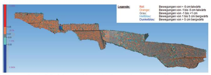
Abb. 7: Darstellung der flächenhaften Verschiebungen der Schwergewichtsmauer von 2012 bis 2014.
