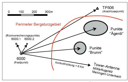
Abb. 3a: Schematischer Netzaufbau 1989, Teilnetze «Ägerdi» und «Brunni».
