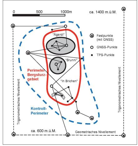
Abb. 4: Schematischer Netzaufbau des heutigen Gesamtnetzes.
