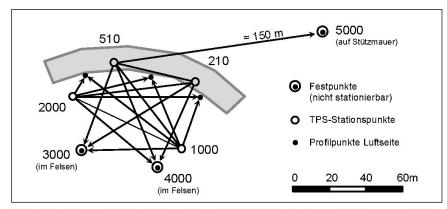
Abb. 3b: Schematischer Netzaufbau 1989, Teilnetz Sperre (Schwergewichtsmauer) «In Brüchen».
