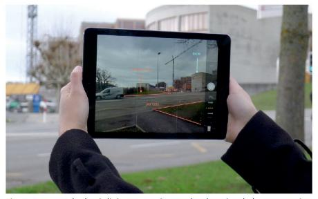
Fig. 1: Un exemple de réalité augmentée avec les données de la mensuration officielle.
