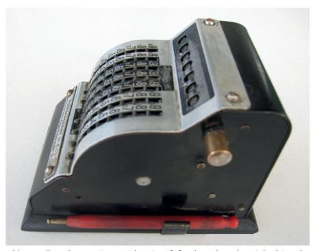
Abb. 2: Volksrechner. Seitenansicht mit Stift für das Zahnradgetriebe (Eingabe der Zahlen) und Löschkurbel fürs Ergebniswerk (Griff fehlt).
