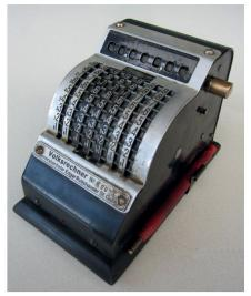
Abb. 3: Der Volksrechner mit Einstellwerk (unten) und Eingabestift sowie Ergebniswerk (oben) mit Löschkurbel (ohne Griff).
