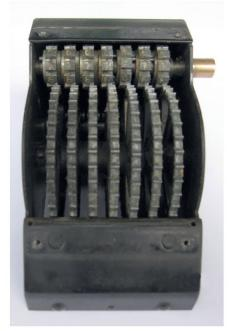
Abb. 4: Ein Blick ins Innere des Volksrechners zeigt die Zahnränder des Einstellwerks (unten) und des Ergebniswerks (oben).
