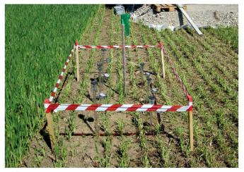
Abb. 7: Tensiometermessfeld mit je 3 Tensiometern im Abb. 8: Dank der Baupiste können Transporte wetterunab-Ober- und Unterboden sowie einem Regenmesser.
