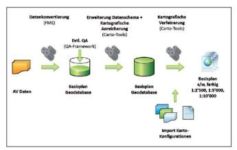
Abb. 3: Arbeitsablauf für die automatische Erstellung Basisplan der amtlichen Vermessung (BP-AV).
