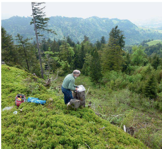
Abb. 2: Setzen der Passpunktsignale (Bild: Ingenieure Bart AG).
