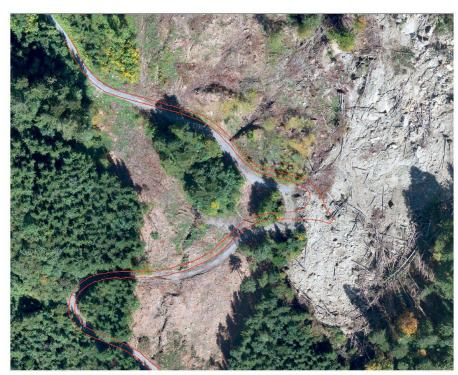
Abb. 7: Veränderung an der Howaldstrasse: Die Strasse wurde im Einflussbereich der Rutschung seit Rutschungsabgang bis maximal 6m talwärts verschoben; ein Grossteil dieser Bewegungen geschah im Laufe der Folgerutschung (Bild: Ingenieure Bart AG).
