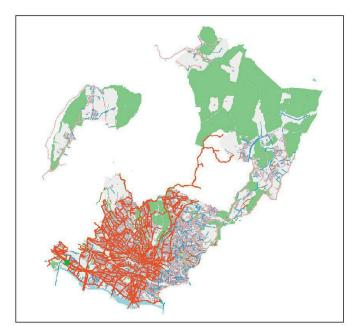
Fig. 9: Rete unitaria collegata all'IDA di Vidy. Abb. 9: An die ARA von Vidy angeschlossenes Mischnetz. Fig. 9: Réseau unitaire connecté à la STEP de Vidy.
