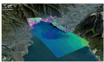
Fig. 4: Acquisition des données collectées le 7 mars 2014 au-dessus de la partie Est du lac Léman (delta du Rhône): (a) trajectoire de vol en jaune et mesures *in situ* en rouge; (b) visualisation 3-D des données hyperspectrales orthorectifiées et géoréférencées.
