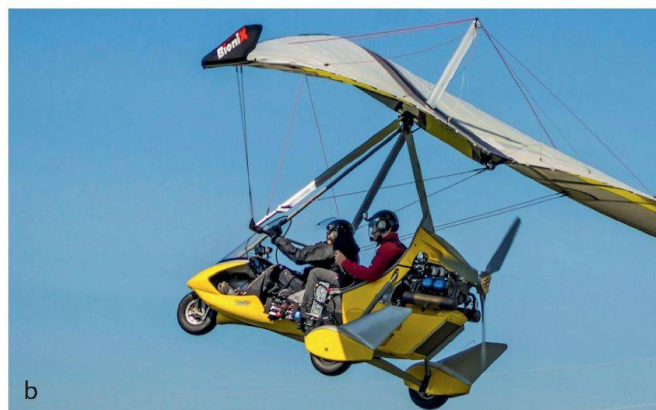
Fig. 2: Plateforme d'imagerie multi- et hyper-spectrale pour la télédétection (a) installée sur un ULM Tanarg 912S de Air Création (b).
