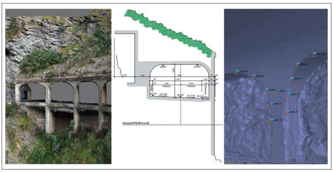
Abb. 3: Punktwolke aus UAV-Befliegung, Planerstellung und trianguliertes Modell der terrestrischen Aufnahme.
