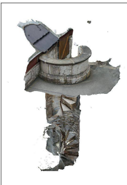
Abb. 3: 3D-Dreiecksvermaschungen der Wendeltreppe.
