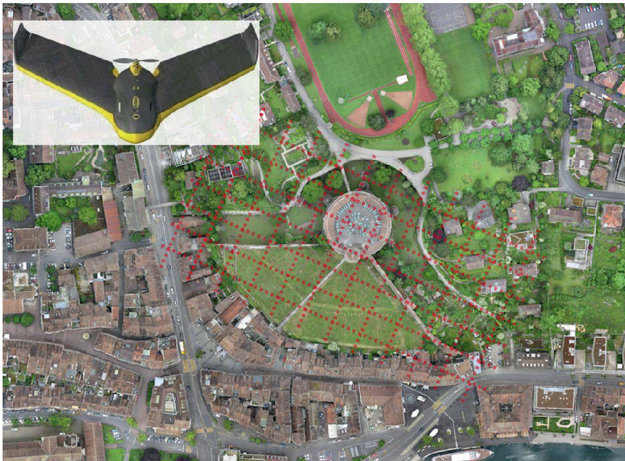
Abb. 2: eBee-Microdrohne (oben links) und True-Orthophotomosaik des befliegen Gebiets (inkl. skizzierte Fluglinien).
